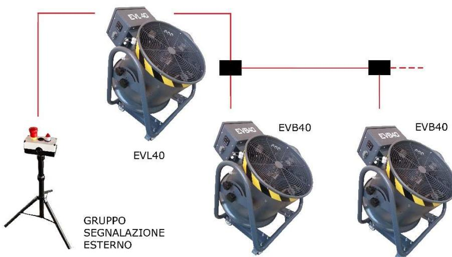
Configurazione "flotta" con segnalazione/controllo fermata esterna al locale in fase di trattamento
