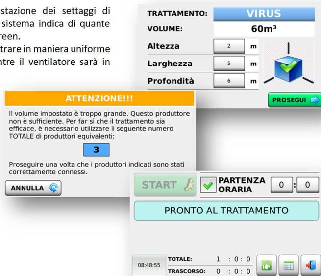
N.B.: lo start e lo stop sono gestibili oltre che in automatico anche tramite il telecomando in dotazione.
